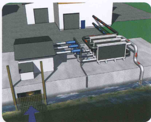
Översiktsbild på en av BernoulliFilterets huvud-applikationer, skydd av värmeväxlare.
